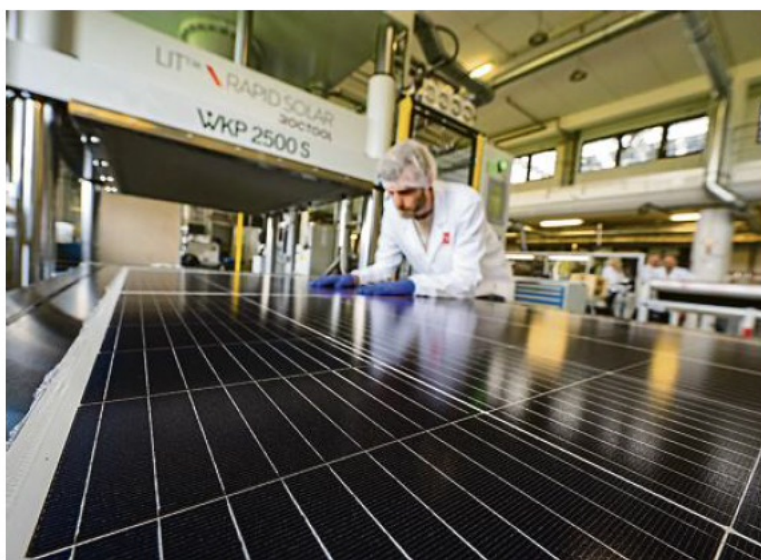
Un brevet a été déposé pour un équipement de thermocompression par induction. Photo L. Godart/CEA
