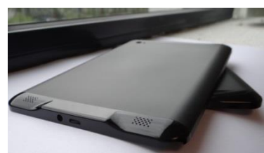
Épaisseur de moins d'1mm, qualité de surface parfaite en sortie de moule, combinaison high-gloss, low gloss
