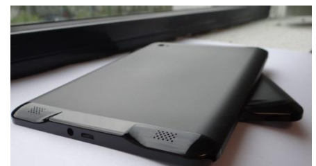
Stärke von weniger als 1 mm, perfekte Oberflächenqualität nach Entformung, Kombination von Hoch- und Mattglanz
